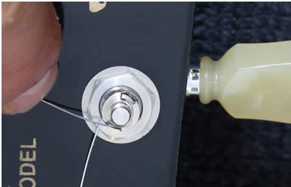
*Enroulez les cordes dans le même sens (sens des aiguilles d'une montre) que le sens de serrage de la capsule de la mécanique. Assurez-vous d'enrouler les cordes de si et de mi aigu en effectuant deux tours complets avant de resserrer la capsule.*
